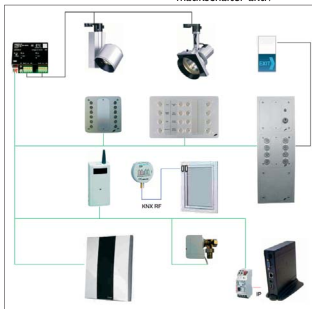
Bedien- und Meldekonzept mit KNX / CIBEK Touch Panel – developed for central operation and monitoring
